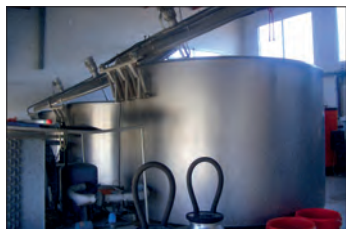
Depósitos independientes con refrigeración automática de 2.000-2.500 litros
